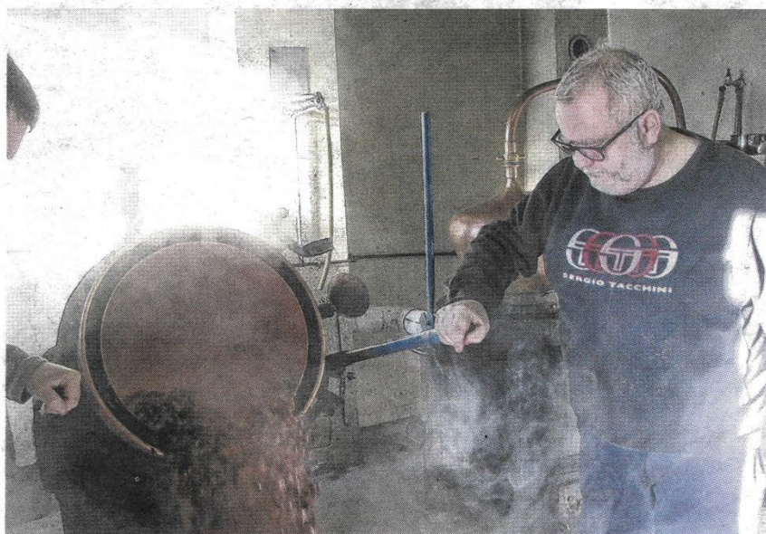
La cuite est finie... La vidange de l'alambic est facilitée par un système à bascule, chez les bouilleurs de cru de Giromagny.
